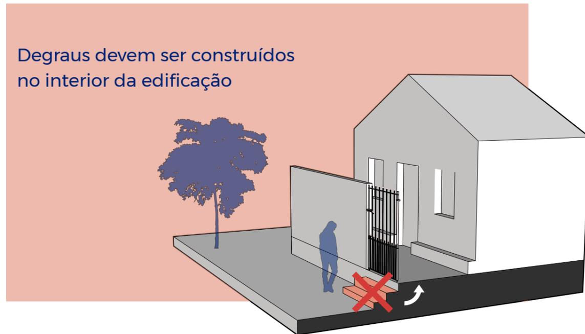
Figura 19: Situação errada: Degraus no exterior da edificação.
